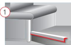
Nos rubans adhésifs pour le montage d'accessoires, comme les panneaux, les baguettes et les profilés, assurent une fixation invisible, propre et fiable.
