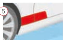
Nos films de protection peinture extrêmement résistants aux UV, fins et quasiment invisibles, protègent le véhicule contre la projection de gravillons et les rayures.
